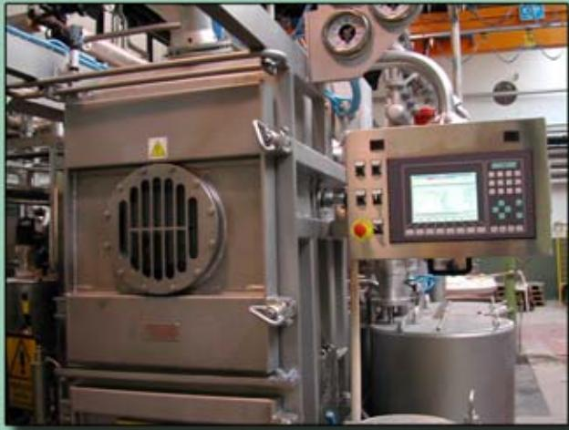
**Il sistema MULTIMACCHINA realizzato su piattaforma DCS, permette di controllare con un unico PC, più macchine, anche diverse tra loro.**
